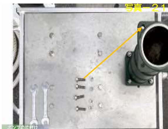
外したボルトナットはポンプに留めておく
