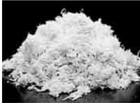
◀ 白石綿(クリソタイル)
