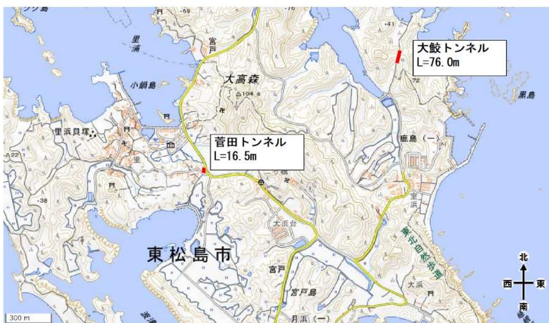
国土地理院電子地図閲覧サービスより出力した地形図に、トンネル位置を追記。
