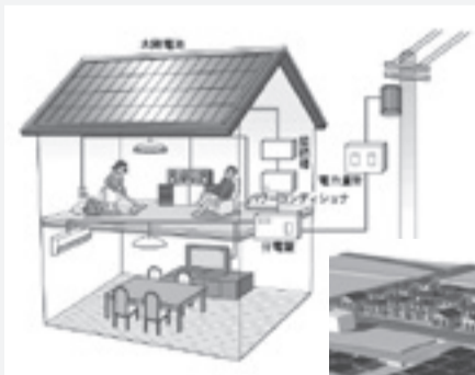
家屋用太陽光発電設備の一例
