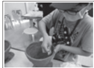
水漏れを防ぐため、貝殻で内側を丁寧に磨きます。
